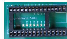
**Abb. 2: Arduino-Nano-Sockel**
